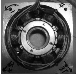
图12 无轴承薄片永磁电机原理样机
