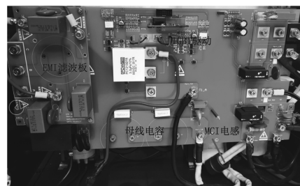
图12 等离子切割电源MCI实验平台
