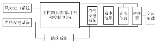
图1 风—光—沼互补发电系统结构
